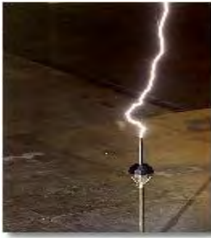
Figure 3 : Test de PDA en laboratoire
